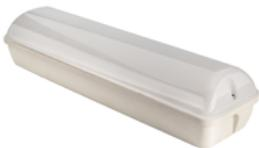
СВЕТОДИОДНЫЙ АНТИВАНДАЛЬНЫЙ СВЕТИЛЬНИК (для ЖКХ), корпус - АБС-сополимер, стандартный цвет светло-серый. Рассеиватель - опал (поликарбонат, светопрозрачность - 85%). IP65
